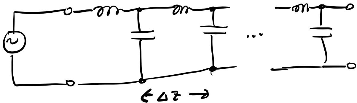
Found  $V(z) = V_+ e^{-j\beta z} + V_- e^{j\beta z}$
